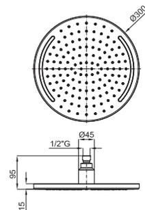
**1** LIGHT COLOR ROUND - Распылитель Light Color Round 30см, с шарниром. Функция душа: дождевой. Дополнительная функция: красно-синий свет с сенсором температуры при 38°C (led). Не требует подсоединения к электросети. Минимальное рекомендуемое давление 2 бара. Включает ограничитель. Пропускная способность воды до 12 л/мин.
