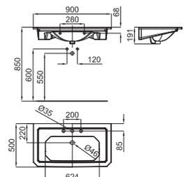
**1** Умывальная раковина-консоль 90 см, подвесная, с переливом. В комплект включен набор крепежных элементов 100041225 - N421040000. Совместима с комплектом ножек для консоли. С одним отверстием для смесителя
