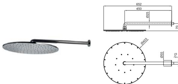
TONO. Комплект верхнего душа 400мм + кронштейн 450мм. Пропускная способность при 3 бар – 20 л/мин.
