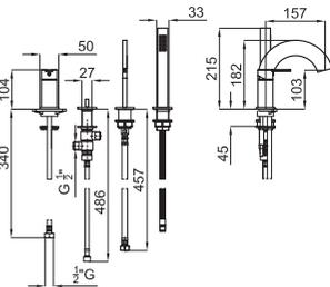
Смеситель для ванны на 4 отверстия. Он включает пульт, излив для ванны, переключатель и ручной душ со шлангом на 150-см. Связь 3/8" и плоский аэратор. Пропускная способность при 3 барах ванна: 9,54 л/мин. и душа 11,04 л/мин.
