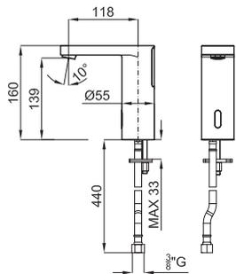
HOTELS - Электронный смеситель с одним подводом воды, подключение 3/8" без сливного клапана и с аэратором "plus". Батарея 3В. Пропускная способность при 3 барах - 5 л/мин.
