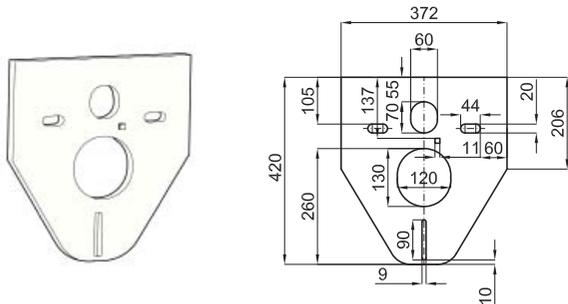
Защитная прокладка с акустической изоляцией для установки между подвесным унитазом или биде и керамической облицовкой стены.
