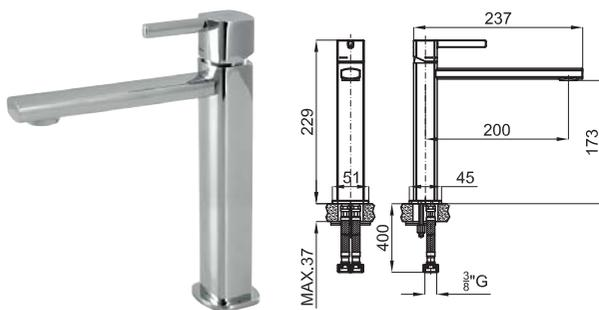
Высокий однорычажный смеситель 229мм, керамический картридж 25 мм. Без донного клапана. Соединения 3/8", длина шланг 400мм. Аэратор "plus". Пропускная способность при 3 барах - 5л/мин.
