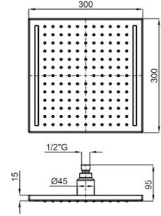
**1** LIGHT SQUARE - Распылитель Light Square 30 см, с шарниром. Функция душа: дождевой. Дополнительные функции: белый свет (led). Не требует подсоединения к электросети. Минимальное рекомендуемое давление 2 бара. Включает ограничитель Пропускная способность воды до 12 л/мин.
