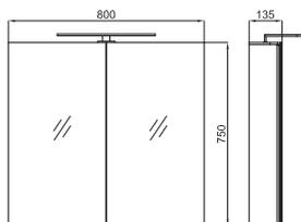
Шкаф подвесной с двумя дверцами, двойным зеркалом и подсветкой 80x75x13,5 см. Сенсор включения подсветки. Зеркало со встроенной системой предотвращающей запотевание. Максимальная мощность электроприбора подключаемого в розетку - 500Вт, 2 стеклянные полочки регулируемые по высоте. Зеркальная задняя стенка. Петли с системой мягкого закрывания. Блестящий алюминиевый профиль "soft line". Класс электробезопасности II.
