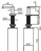
Дозатор мыла встраиваемый в столешницу
