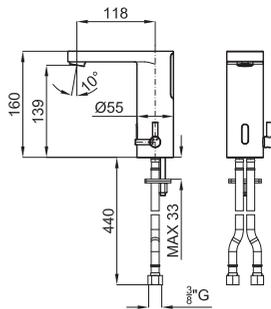
HOTELS - Электронный смеситель с двумя подводами воды, подключение 3/8" без сливного клапана и с аэратором "plus". Батарея 3В. Пропускная способность при 3х барах со смешанной водой 5л/мин
