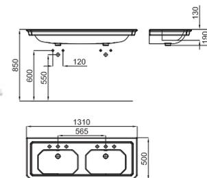
1 IMAGINE. Умывальная раковина-консоль 130 см, подвесная, с переливом. В комплект включен набор крепежных элементов 100041225 - N421040000. Совместима с комплектом ножек для консоли. С одним отверстием для смесителя
