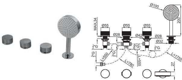
Комплект для установки на борт ванны. Включает вентили холодной/горячей воды, переключатель и душ с держателем.
