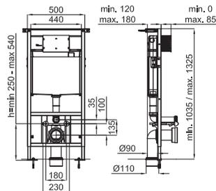
Рама + Универсальный встроенный бачок для подвесного унитаза. Установка в тонкую стену с набором креплений и трубой соединения с унитазом.
