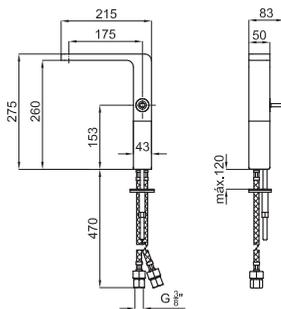
Однорычажный смеситель для раковины с высоким изливом и керамическим картриджем Ø25 мм. Связь 3/8". Длина шлангов 470 мм, без клапана слива. Включает аэратор, вмонтированный в излив, который имитирует эффект падения воды каскадом, кроме того смеситель со стопором давления в 8 л/мин, чтобы предотвращать забрызгивание.
