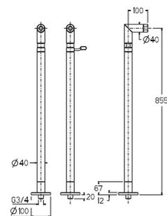
1 Смеситель-моноблок для ванна / душа с керамическим картриджем для установки с набором стоек. Подключение 3/4", ручной переключатель и азратор "plus". В комплект не входит ручной душ, ни шланг, ни держатель. Пропускная способность при 3 барах 33 л/мин.
