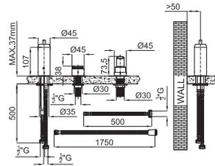
PROJECT LINE - Внутренний корпус смесителя, установка на ванне. Керамический картридж TRI-CONTROL Ø40 мм со встроенным переключателем.
