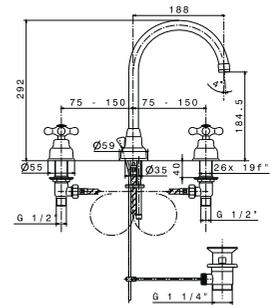
1 Смеситель для раковины на 3 отверстия с керамическим картириджем. Связь 1/2", длина шлангов 365-мм, с автоматическим клапаном слива и аэратор "plus". Пропускная способность при 3 барах 19,26 л/мин.
