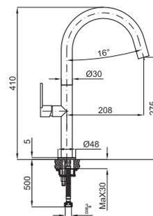
1 URBAN - Однорычажный смеситель для мойки, поворотный излив, с выдвижным душем. Включает керамический картридж Ø25, с подключением 3/8", длина шлангов 500-мм. Аэратор "Plus".
