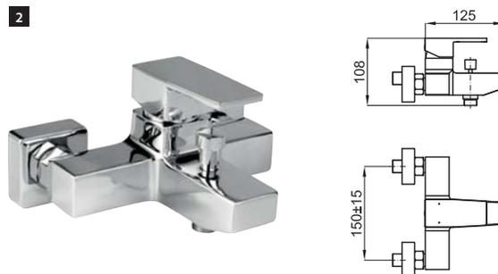
1 Наружный однорычажный смеситель с керамическим картриджем Ø35 мм. и связь 1/2". Расстояние между выходами 150 +/-15 мм. Пропускная способность при 3 барах 20,08 л/мин.
