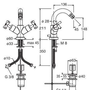
Смеситель-моноблок для биде с керамическим картриджем. Связь 3/8", длина шлангов 350-мм, с автоматическим клапаном слива и аэратор "plus". Пропускная способность при 3 барах 12,78 л/мин.
