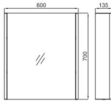
Шкаф подвесной с одной дверцей, двойным зеркалом и боковой подсветкой 60x70x13,5 см. Сенсор включения подсветки. Зеркало со встроенной системой предотвращающей запотевание. Максимальная мощность электроприбора подключаемого в розетку - 500Вт; 2 стеклянные полочки регулируемые по высоте. Зеркальная задняя стенка. Петли с системой мягкого закрывания. Блестящий алюминиевый профиль "soft line". Класс электробезопасности II.
