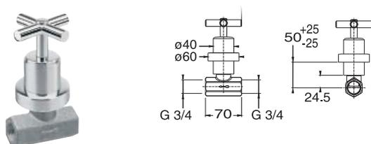
Перепускной вентиль, скрытого монтажа, 3/4". Пропускная способность при 3 барах 36 л/мин.
