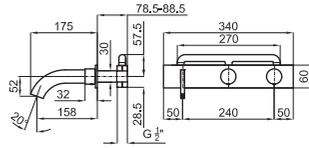
Смеситель-моноблок на раковину, скрытого монтажа, с керамическим картриджем. Связь 1/2", без клапана слива и с плоским эффектом падения воды каскадом. Пропускная способность при 3 барах 6,6 л/мин.
