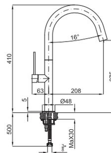
2 URBAN STICK - Однорычажный смеситель для мойки, поворотный излив. Включает керамический картридж Ø25 мм., с подключением 3/8", длина шлангов 500-мм. Аэратор "Plus".
