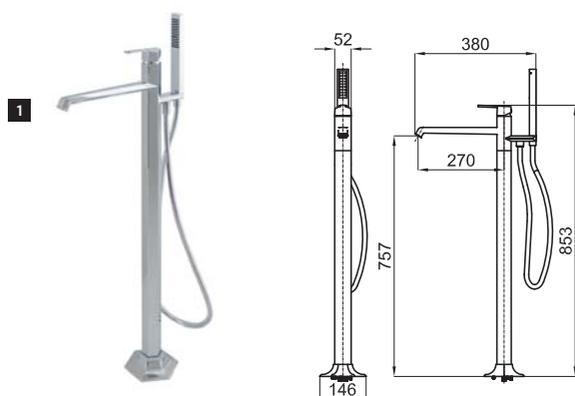
1 Напольный смеситель для ванной/душа, с гибким шлангом 100137846 - N199999498 и ручным душем COTA 100038634-N158760001. Керамический картридж TRI-CONTROL Ø40см со встроенным переключателем. Необходим внутренний корпус Smartbox для напольного смесителя 100149141 - N199999397
