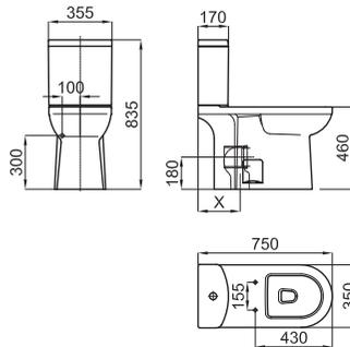
1 EASY PMR. Напольный унитаз с направляемым выходом для людей с ограниченными возможностями. Включает 2 комплекта крепежа 100040452-N301150000
