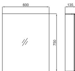
Шкаф подвесной с одной дверцей и двойным зеркалом 60x75x13,5 см. 2 стеклянные полочки регулируемые по высоте. Зеркальная задняя стенка. Петли с системой мягкого закрывания. Блестящий алюминиевый профиль "soft line".
