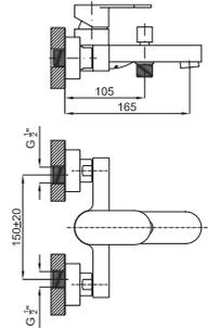
1 Наружный однорычажный смеситель для душа с керамическим картриджем Ø35 мм. Подключение 1/2". Расстояние между выходами 150 +/-15 мм.
