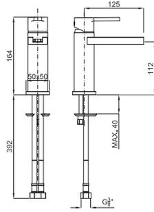
Однорычажный смеситель для раковины с керамическим картриджем Ø25 мм. Связь 3/8", длина шлангов 390-мм, без клапана слива. Падение воды каскадом. Пропускная способность при 3 барах 4 л/мин.
