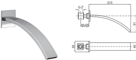
Излив для ванны, скрытого монтажа. Связь 1/2" и без аэратора. Падение воды каскадом. Пропускная способность при 3 барах 32 л/мин.
