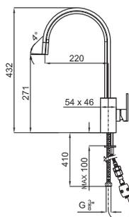
LOOP - Однорычажный смеситель для мойки, поворотный излив, с выдвижным душем. Включает керамический картридж Ø35 мм. с подключением 3/8", длина шлангов 410-мм, аэратор скрытый "plus", обратный клапан и длина шлангов для душа 150-см.
