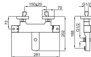
1 ACRO N. Наружный смеситель с термостатом для душа с элементом покрытия из воска. Связь 1/2". Включает обратный клапан и предохранитель на 38° и ECOSTOP. Расстояние между выходами 150 +/-20 мм. Пропускная способность при 3 барах 17,4л
