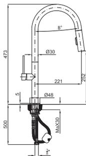
1 URBAN STICK - Однорычажный смеситель для мойки, поворотный излив, с выдвижным душем. Включает керамический картридж Ø25, с подключением 3/8", длина шлангов 500-мм. Аэратор "Plus".
