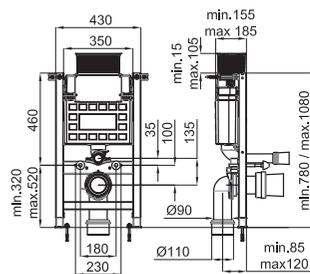
Каркас подвесного унитаза с бачком, укороченный, с подводом сверху или сбоку. Включает комплект для крепления на стену и трубы для соединения с унитазом.
