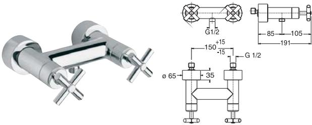
Наружный смеситель-моноблок для душа с керамическим картриджем. Связь 1/2". Расстояние между выходами 150 +/-15 мм. Пропускная способность при 3 барах 33 л/мин.
