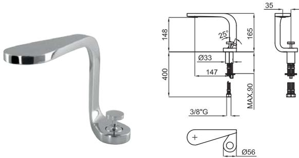
Однорычажный смеситель для раковины с керамическим картриджем Ø25mm. Подключение 3/8". Длина шлангов 365 мм, без сливного клапана. Аэратор "slim". Давление при 3 барах 9 л/мин.
