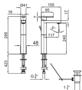
1 Однорычажный смеситель для раковины с керамическим картриджем Ø25 мм. Связь 3/8", длина шлангов 320-мм, с автоматическим клапаном слива и аэратор "plus". Пропускная способность при 3 барах 11,7 л/мин.
