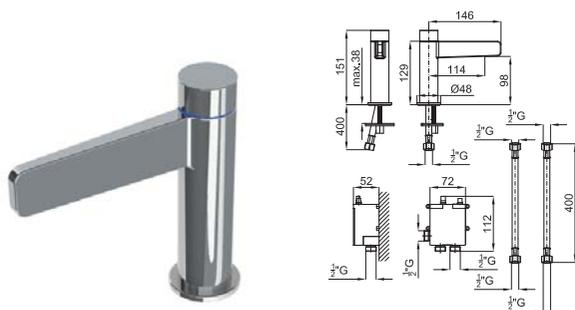
Электронный смеситель для раковины с подключениями 1/2". Без донного клапана. Стоп безопасности, батарея. Необходимо подключение к электросети. Плоский аэратор. В комплект входит трансформатор 100-240V, 50/60 Hz, выходное напряжение 9.0V. Наружный смеситель 85x75x55мм.
