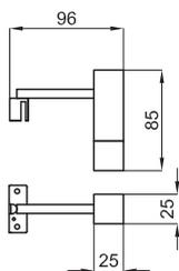
ACRO. Бра LED Acro 3Вт для установки на зеркале. 12 V, IP44.
