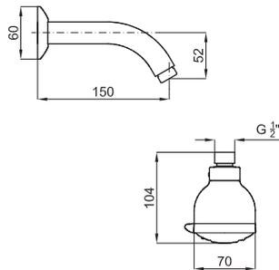
PROJECT - Душ стационарный с подключением 1/2". Функции: Дождь, Массаж и Дождь+Массаж. Включает систему антиизвесть.
