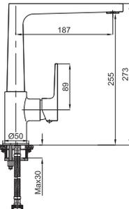
ARQUIТЕКТ - Однорычажный смеситель для мойки, поворотный излив. Включает керамический картридж Ø35 мм, с подключением 3/8", длина шлангов 500-мм. Аэратор "Plus".
