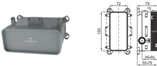
корпус SMART BOX BATH для установки смесителя для раковины. Керамический картридж Ø35мм и соединения 1/2". Возможность установки в горизонтальном и вертикальном положении.
