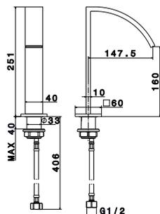
Отдельный высокий излив. Связь 1/2", длина шлангов 406-мм, без клапана слива и без аэратора. Падение воды каскадом. Внимание: подход воды только один. Пропускная способность при 3 барах 25,54 л/мин.
