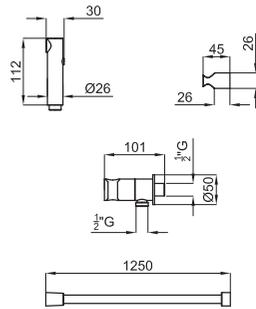
ROUND - Комплект гигиенического душа. Включает гигиенический душ, шланг 120см в металлической обмотке и запорный вентиль с держателем и функцией автоматического перекрытия воды
