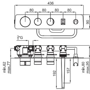
Термостатический смеситель скрытого монтажа с термоэлементом из воска, обратным клапаном и изливом для ванны. Подключения 3/4". Пропускная способность при 3 барах душа: 14,6 л/мин. и душа: 16,4 л/мин.
