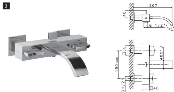
**1** Наружный смеситель-моноблок для душа с керамическим картриджом. Связь 1/2". Расстояние между выходами 150 +/-20 мм. Пропускная способность при 3 барах 30,56 л/мин.
