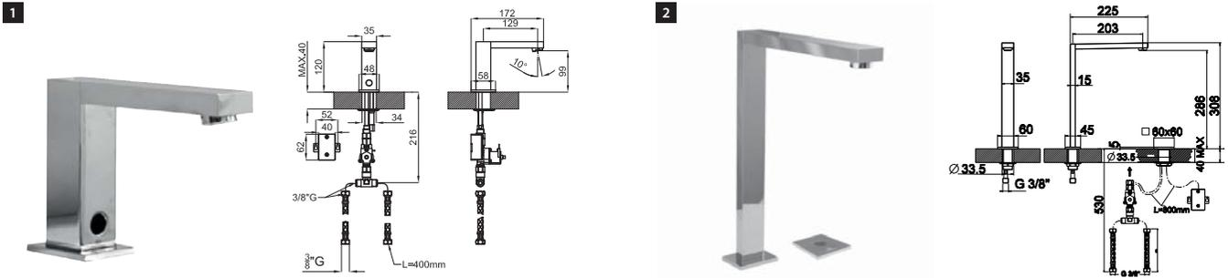
**1** Электронный смеситель для раковины со подключениями 3/8", без клапана слива и аэратор "plus". Два подвода воды, регулировка температуры производится под столешницей. Пропускная способность при 3 барах 10,5 л/мин.
