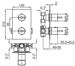
Смеситель с термостатом, скрытого монтажа, с 1 выходом, включает элемент покрытия из воска. Связь 1/2". Пропускная способность при 3 барах - 28,25 л/мин. Он включает обратный и стоп для безопасности в 38°C.
