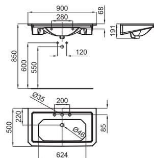
1 IMAGINE. Умывальная раковина-консоль 90 см, подвесная, с переливом. В комплект включен набор крепежных элементов 100041225 - N421040000. Совместима с комплектом ножек для консоли. С одним отверстием для смесителя
