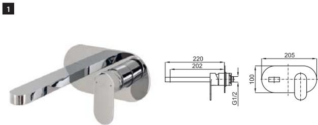
1 Внешняя часть, встроенного смесителя для раковины с керамическим картриджем 35мм. Без донного клапана. Пропускная способность воды при 3 барах - 5 л/мин. Возможность горизонтального и вертикального монтажа.
