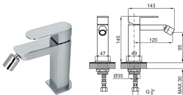
Однорычажный смеситель для биде с керамическим картриджем Ø25 мм. Подключение 3/8", длина шлангов 370-мм, без автоматического клапана слива и с аэратор "plus". Пропускная способность при 3 барах 9 л/мин.
