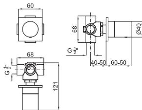
Переключатель 3 пути с подключением 1/2". Пропускная способность при 3 барах душа: 15 л/мин., ванны: 25 л/мин. и верхний душ: 17 л/мин.
