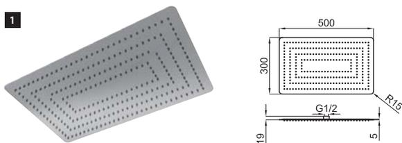
**1** NK LOGIC. Верхний душ Recto 50x30 см, без шарового соединения. Пропускная способность при 3 барах
