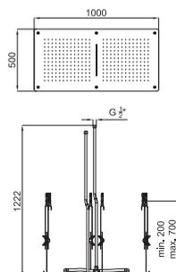
NK LOGIC. Универсальный встроенный верхний душ Resto 100x50 см с функцией падения воды каскадом. Душ можно включать с каждой стороны отдельно или вместе.
