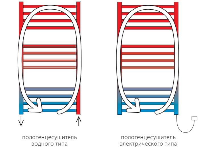
Жидкость полотенцесушителя теряет энергию в форме тепла, которая посредством излучения поступает через трубы полотенцесушителя во внешнюю среду. Эта тепловая энергия восполняется через нагревание с помощью бойлера.
