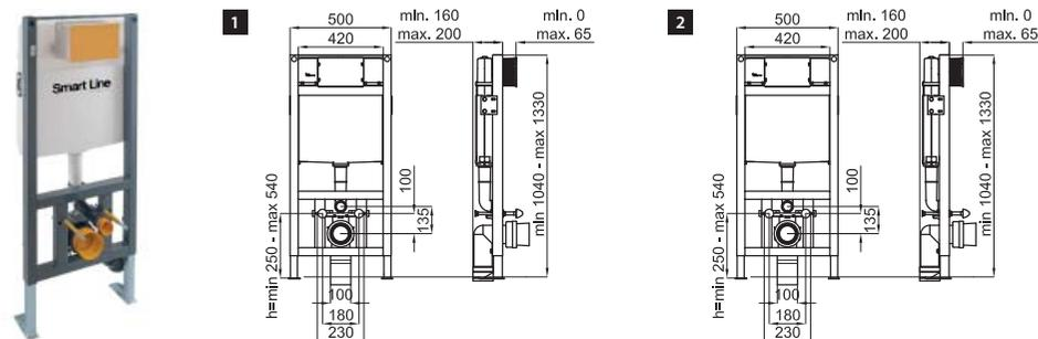
**1** Рама + Универсальный встроенный бачок для унитаза подвесного, система самонесущая с набором настенных креплений и трубой соединения с унитазом.
