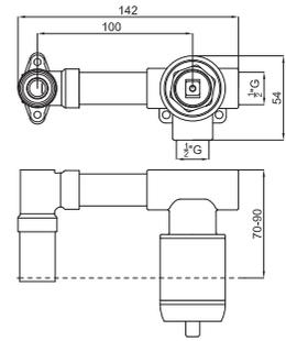
1 Наружная часть однорычажного смесителя для раковины скрытого монтажа с ребристой рукояткой и круглым изливом. Пропускная способность при 3 барах 5,68 л/мин
