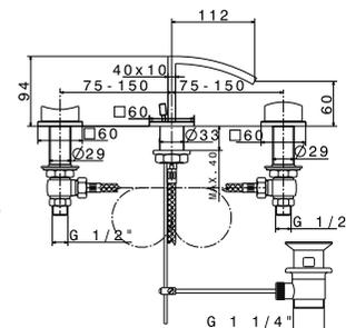
1 Однорычажный смеситель для биде с керамическим картриджом Ø28 мм. Связь 3/8", длина шлангов 541-мм, с автоматическим клапаном слива и без аэратора. Падение воды каскадом. Пропускная способность при 3 барах 7,36 л/мин.
