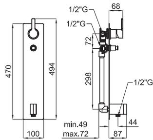
Однорычажный смеситель скрытого монтажа для ванны / душа, с керамическим картриджом Ø35 мм. Связь 1/2". Он не включает ни ручной, ни гибкий душ. Пропускная способность при 3 барах душа: 14,9 л/мин. и ванны: 20,2 л/мин.
