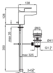
Однорычажный смеситель для раковины с керамическим картриджем Ø35 мм, связь 3/8", длина шлангов 370-мм, с автоматическим клапаном слива и аэратор "plus". Пропускная способность при 3 барах 12,01 л/мин.
