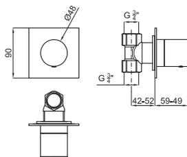
Переключной вентиль с подключением 3/4". Пропускная способность при 3 барах 85,09 л/мин.
