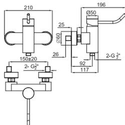
1 Однорычажный смеситель, скрытого монтажа, для душа с керамическим картриджем Ø40 мм. и связь 1/2". Давление в 3 бара - 35,7 л/мин. Пропускная способность при 3 барах 22,6 л/мин.
