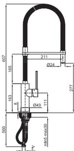
SPRING - Однорычажный смеситель для мойки, поворотный излив. Включает керамический картридж Ø35 мм., с подключением 3/8", длина шлангов 500-мм. Аэратор "Plus".
