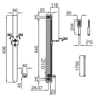
Комплект для душа Forma. В комплект входит душевая Пьедестал с реечным механизмом скольжения и поворотным кронштейном, ручной душ, гибкий шланг с системой анти-скручивания и покрытием из ПВХ, подвод воды
