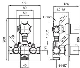
Смеситель с термостатом, скрытого монтажа, на 3 отверстия (2 ручных душа) с элементом покрытия из воска. Связи 1/2"- 3/4" согласно плану. Регулирующий переключатель давления. Включает обратный клапан и предохранитель на 38°C. Давление в 3 бара (со смешанной водой) за 1 выход 22,5 л/мин. и для других 2 выхода 15 л/мин.
