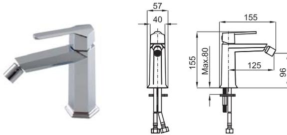
Однорычажный смеситель для биде с керамическим картриджем Ø25 мм. Подключение 3/8", длина шлангов 480-мм, без автоматического сливного клапана. Пропускная способность при 3 барах 8,32 л/мин.
