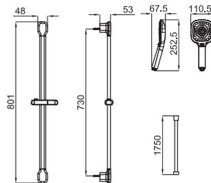
Комплект для душа URBAN. Включает планку для душа с держателем, ручной душ URBAN 100094156 - N199999731 с 2 функциями и гибкий шланг с покрытием PVC и системой антискручивания 100137848 - N199999490.
