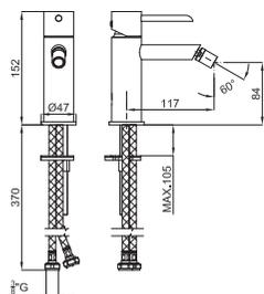
Однорычажный смеситель для биде с керамическим картриджем Ø35 мм. Подключение 3/8", длина шлангов 370-мм, без автоматического сливного клапана и с азратором "plus". Открытие на холодную. Пропускная способность при 3 барах 11,73 л/мин.
