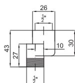
Эксцентрическое соединение 10 мм. 1/2" - 1/2" хромированное.
