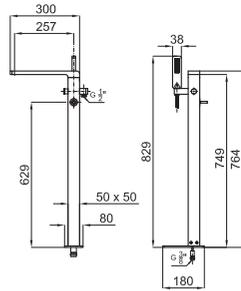
Однорычажный смеситель для ванны / душа монтируемый в пол. Связь 3/8". Автоматический переключатель. Включает аэратор. Пропускная способность при 3 барах ванна: 14,83 л/мин. и душа 14,12 л/мин.
