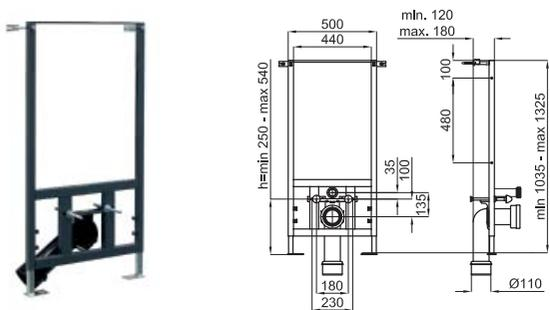
Рама без бачка для подвесного унитаза. Установка в тонкую стену. В комплект входят крепежные элементы и трубы соединения с унитазом.
