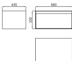
Подвесной модуль шириной 68 см, покрыт блестящим лаком. Ящик с доводчиком обеспечивающим замедленное закрывание.
