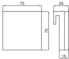
FORMA. Бра LED квадратной формы 5Вт для установки на зеркале. 12 V, IP44.
