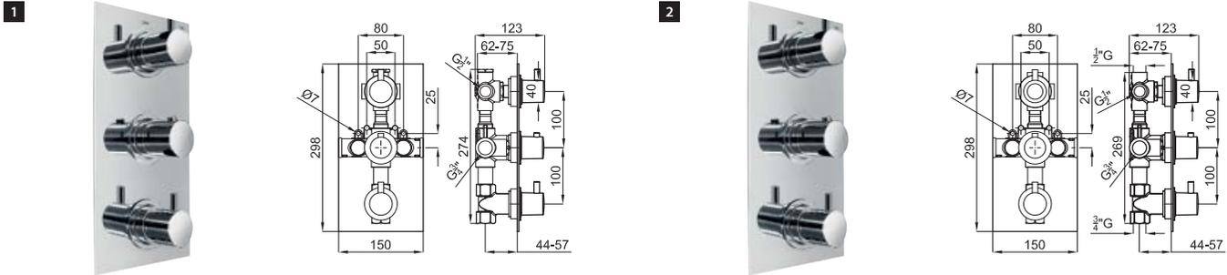
**1** Смеситель с термостатом, скрытого монтажа, на 3 отверстия с элементом покрытия из воска. Связи 1/2" - 3/4" согласно плану. Регулирующий переключатель давления. Пропускная способность при 3 барах - 1 выход 26 л/мин., другой с 16 л/мин. и последний 45,5 л/мин. Включает 1 выход большого давления с независимым ручным душем, клапан слива анти-возвращения и предохранитель на 38°C
