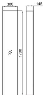
Шкаф подвесной с одной дверцей и двойным зеркалом 30x170x14,5 см. 5 стеклянных полок регулируемых по высоте. Зеркальная задняя стенка. Петли с системой мягкого закрывания. Блестящий алюминиевый профиль "soft line".
