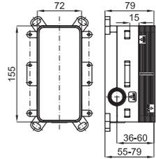
**1** Внешняя часть, встроенного смесителя для раковины с керамическим картриджем 35мм. Без донного клапана. Пропускная способность воды при 3 барах - 5 л/мин. Возможность горизонтального и вертикального монтажа.
