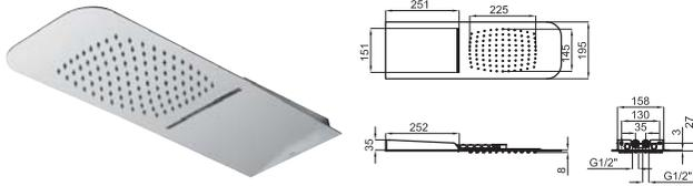
Распылитель дождевого душа с закругленными краем, 60 см, дождевой + каскадный. Пропускная способность при 3 барах дождевого: 14 л/мин. и каскада: 15,50 л/мин.
