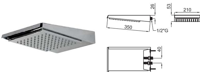
Распылитель с функцией дождевого душа и каскада, с соединениями 1/2". Пропускная способность при 3 барах функцией дождевого душа: 12 л/мин. и каскада: 8,6 л/мин.
