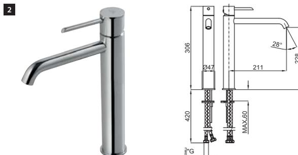
**1** Высокий однорычажный смеситель 200мм, керамический картридж 35 мм. Без донного клапана. Соединения 3/8", длина шланг 430мм. Аэратор "plus". Пропускная способность при 3 барах - 5,34л/мин.
