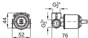
PROJECT LINE - Внутренняя часть встроенного смесителя для душа с керамическим картриджем 35мм и подключениями 1/2". Пропускная способность при 3х барах со смешанной водой 21л/мин
