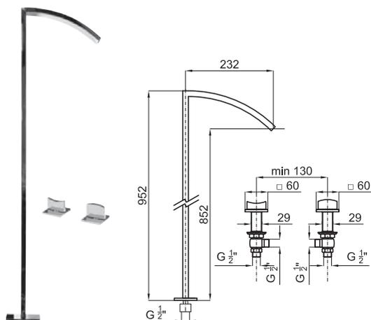
Комплект перепускных вентилей для установки на ванну с изливом, монтируемым в пол. Включает 2 типа пульта и монтаж в пол. Связь 1/2" и без аэратора. Падение воды каскадом. Пропускная способность при 3 барах 27,31 л/мин.
