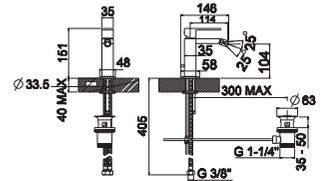
1 Однорычажный смеситель для биде с керамическим картриджем Ø25 мм. Связь 3/8", длина шлангов 405-мм, с автоматическим клапаном слива и аэратор "plus". Пропускная способность при 3 барах 8 л/мин.
