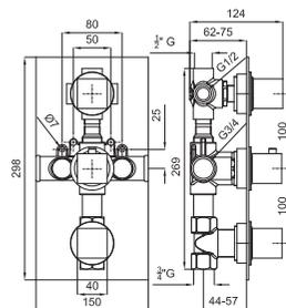
Универсальный встроенный термостат 4 выхода (3 ручки) с восковым термозащитным элементом. Соединения 1/2", 3/4" согласно схеме. Переключатель регулирующий. Пропускная способность. Пропускная способность при 3 барах из 1 выхода - 26,3 л/мин, другого 26,3 л/мин, еще одного 23,1 л/мин и из последнего 45,5 л/мин. Включает 1 выход с большой пропускной способностью и независимой ручкой, обратный клапан и предохранитель на 38°C.
