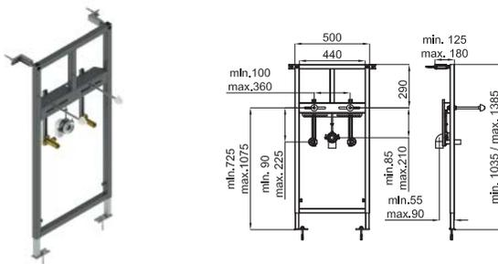
Рама для подвесной раковины. Установка в тонкую стену. Включает комплект креплений и колено-панель для установки подвода воды
