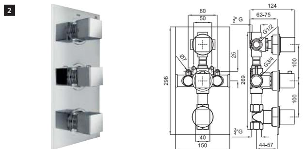
**1** NK LOGIC. Смеситель с термостатом, скрытого монтажа, на 3 отверстия с элементом покрытия из воска. Связи 1/2"- 3/4" согласно схеме. Переключатель регулирующий давление. Пропускная способность при 3 барах - 1 выход 26 л/мин, другой 16 л/мин. и последний 45,5 л/мин. Включает 1 выход с большой пропускной способностью и независимой ручкой, обратный клапан и предохранитель на 38°C.
