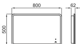
PURE LINE WOOD\_Горизонтальное зеркало 80x50 см, со светодиодной подсветкой по периметру и динамиками для воспроизведения музыки с устройств с поддержкой Bluetooth. II класс электробезопасности, IP44, 50Вт, температура цвета 6000K.
