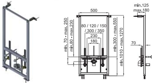
Рама для подвесного биде. Установка в тонкую стену. Включает комплект креплений и колено-панель для установки подвода воды
