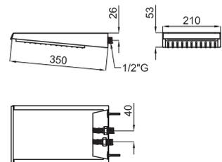
IMAGINE-N. Распылитель с функцией дождевого душа и каскада, с соединениями 1/2". Пропускная способность при 3 барах функцией дождевого душа: 12 л/мин. и каскада: 8,6 л/мин.
