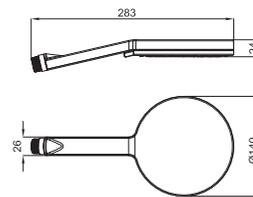
1 HOTELS - Ручной душ с 1 позицией, с системой AIR ECO. Пропускная способность при 3 барах 12 л/мин.
