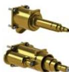
SMART BOX - Универсальный встроенный корпус быстрой установки для термостатических смесителя с 1, 2 или 3 выходами. С восковым термозлементом и подключением 1/2". Пропускная способность всех трех выходов при давлении 3 бар составляет 20,2 л/мин. В комплект входят 2 глушителя шума и 2 заглушки 1/2".
