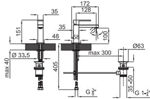
Однорычажный смеситель для раковины с керамическим картриджем Ø25 мм. Связь 3/8", длина шлангов 405-мм, с автоматическим клапаном слива и аэратор "plus". Пропускная способность при 3 барах 10,5 л/мин.
