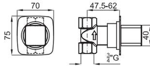
Переключной вентиль с подключением 3/4". Пропускная способность при 3 барах 73 л/мин.
