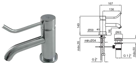
Однорычажный смеситель для раковины с керамическим картриджем Ø35 мм, связь 3/8", длина шлангов 370-мм, с автоматическим клапаном слива и аэратор "plus". Пропускная способность при 3 барах 12,25 л/мин.
