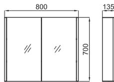
Шкаф подвесной с двумя дверцами, двойным зеркалом и боковой подсветкой 80x70x13,5 см. Сенсор включения подсветки. Зеркало со встроенной системой предотвращающей запотевание. Максимальная мощность электроприбора подключаемого в розетку - 500Вт; 2 стеклянные полочки регулируемые по высоте. Зеркальная задняя стенка. Петли с системой мягкого закрывания. Блестящий алюминиевый профиль "soft line". Класс электробезопасности II.
