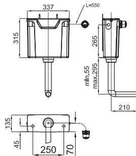
Бачок скрытого монтажа для независимого унитаза, установка в мебель.
