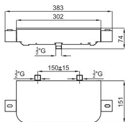
PURE LINE GLASS. Наружный смеситель белое стекло с термостатом для душа с элементом покрытия из воска. Связь 1/2". Включает обратный клапан и предохранитель на 38°. Расстояние между выходами 150 +/-15 мм. Пропускная способность при 3 барах 14,8 l/min
