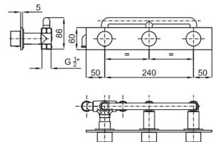
1 Смеситель-моноблок на раковину, скрытого монтажа, с керамическим картриджем. Связь 1/2". Пропускная способность при 3 барах - 50,22 л/мин.
