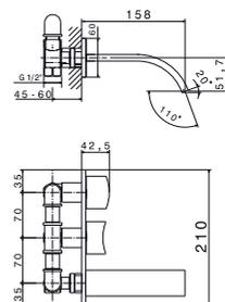
1 Смеситель для раковины на 3 отверстия с керамическим картриджом. Связь 1/2", с автоматическим клапаном слива и без аэратора. Падение воды каскадом. Пропускная способность при 3 барах 25,54 л/мин.
