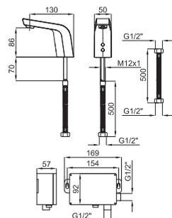
SQUARE - Электронный смеситель с двумя подводами воды, подключение 1/2" без сливного клапана и с аэратором "plus". Батарея 6В. Пропускная способность при 3 барах - 5 л/мин.
