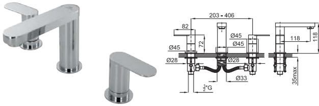
Смеситель для раковины на 3 отверстия с керамическим картриджем. Связь 1/2", без клапана слива. Пропускная способность при 3 барах 5,6 л/мин.
