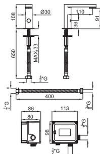
Электронный смеситель с одним подводом воды, подключение 3/8" без сливного клапана. Батарея 3В. Пропускная способность при 3 барах - 6,8 л/мин.
