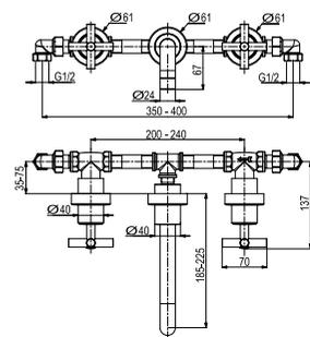
Смеситель, скрытого монтажа, для раковины на 3 отверстия, настенный с керамическим картриджем. Связь 1/2", без клапана слива и аэратор "plus". Пропускная способность при 3 барах 13,06 л/мин.
