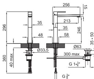
Однорычажный смеситель для раковины с высоким изливом и керамический картриджем Ø25 мм. Связь 3/8", длина шлангов 360-мм, с клапаном слива автоматический и аэратор "plus". Пропускная способность при 3 барах 10,5 л/мин.
