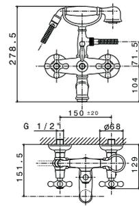
**1** Наружный смеситель-моноблок для душа с керамическим картириджем. Связь 1/2" и аэратор "plus". Включает ручной душ со шлангом 150 см и держатель. Расстояние между выходами 150 +/-20 мм. Пропускная способность при 3 барах 18 л/мин.
