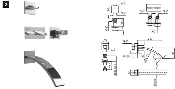
**1** Смеситель, скрытого монтажа, с изливом для ванны. Керамический картридж. Связь 1/2" и излив для ванны, без аэратора. Падение воды каскадом. Пропускная способность при 3 барах 32 л/мин.
