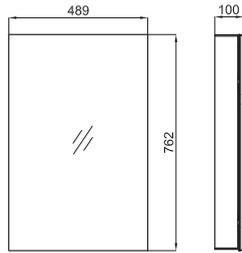
Шкаф Универсальный встроенный с одной дверцей и двойным зеркалом 48,9x76,2x10 см. Зеркало со встроенной системой предотвращающей запотевание. Максимальная мощность электроприбора подключаемого в розетку - 500Вт. 2 стеклянные полочки регулируемые по высоте. Зеркальная задняя стенка. Петли с системой мягкого закрывания. Блестящий алюминиевый профиль "soft line". Класс электробезопасности II.
