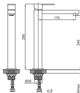
HOTELS - Однорычажный смеситель для мойки, поворотный излив. Включает керамический картридж Ø35 мм, с подключением 3/8", длина шлангов 370-мм. Аэратор "Plus".
