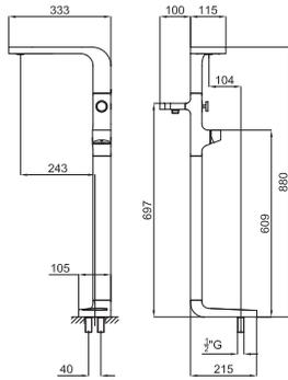
Однорычажный смеситель для ванны / душа монтируемый в пол. Подключение 1/2". Автоматический переключатель. Включает аэратор. В комплект входит ручной душ, шланг и держатель. Напор воды 3 бар ванна 21 л/мин., душ – функция дождь 6 л/мин., спрей 3 л/мин
