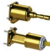
SMART BOX - Универсальный встроенный корпус быстрой установки для смесителя с 2 или 3 выходами. С керамическим картриджем Ø35 мм и подключением 1/2". Пропускная способность всех трех выходов при давлении 3 бар составляет 20,1 л/мин. В комплект входят 2 глушителя шума и 2 заглушки 1/2".
