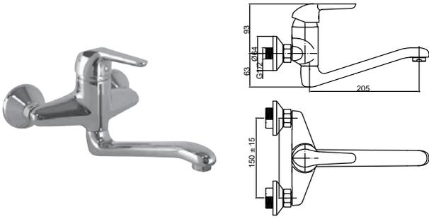
MINI PLUS - Однорычажный смеситель для мойки с поворотным изливом с керамическим картриджем Ø40 mm, с подключением 3/8" и аэратор "plus". Расстояние между выходами 150 +/-20 mm.
