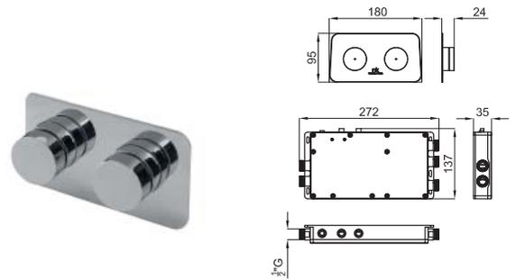
1 Цифровой термостат на 2 выхода с подключениями 1/2" и обратным клапаном. 2 ручки управления со светодиодной подсветкой. Стоп безопасности. Пропускная способность при 3 бар 27,5 л/мин. В комплект входит трансформатор 100-240V, 50/60 Hz выходное напряжение 15.0V. Термостат независимый 225x130x55мм.
