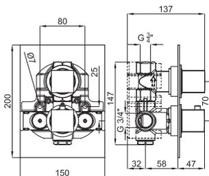
NK LOGIC. Смеситель с термостатом, скрытого монтажа
