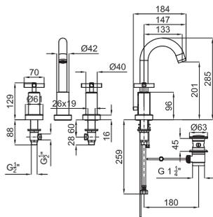
Смеситель для раковины на 3 отверстия с керамическим картриджем. Связь 1/2", длина шлангов 259-мм, с автоматическим клапаном слива и аэратор "plus". Пропускная способность при 3 барах 12,78 л/мин.
