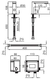
TONO. Электронный смеситель с одним подводом воды, подключение 3/8" без сливного клапана. Батарея 3В. Пропускная способность при 3 барах - 6.8 л/мин.
