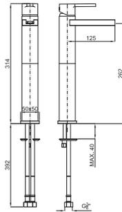
Однорычажный смеситель для раковины с высоким изливом и керамическим картриджем Ø25 мм. Связь 3/8", длина шлангов 390-мм, без клапана слива. Падение воды каскадом. Пропускная способность при 3 барах 4 л/мин.
