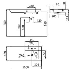
**1** Умывальная раковина 100x45 см, подвесная, с центрированным углублением и переливом. Включает крепежные элементы 100041225 - N421040000.
