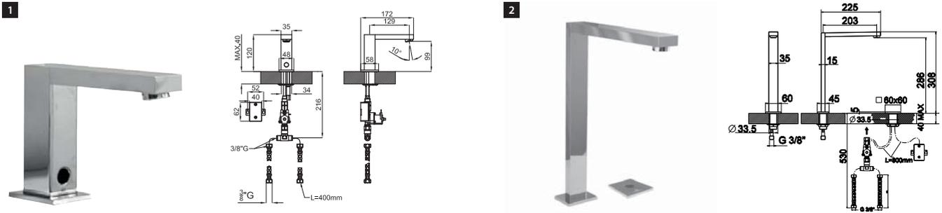
**1** IRTA. Электронный смеситель для раковины со подключениями 3/8", без клапана слива и аэратор "plus". Два подвода воды, регулировка температуры производится под столешницей. Пропускная способность при 3 барах 10,5 л/мин.
