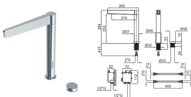
PURE LINE - Кухонный электронный смеситель с поворотным изливом и отдельной кнопкой управления. Подключения 1/2", стоп безопасности, батарея, плоский аэратор. Необходимо подключение к электросети. В комплект входит трансформатор 100-240V, 50/60 Hz выходное напряжение 9.0V. Наружный смеситель 85x75x55мм.
