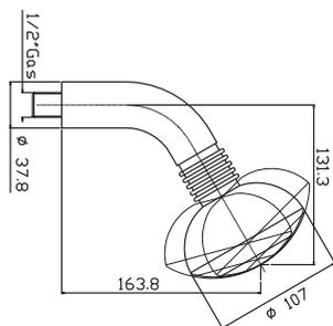
STYLO - Душ стационарный с подключением 1/2". Функции: Дождь, Массаж и Софт. Включает систему антиизвесь.
