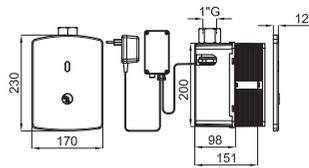
Инфракрасная система смыва для унитаза с пьезоэлектрической кнопкой. Установка в капитальную стену. В комплект входит трансформатор 9В.
