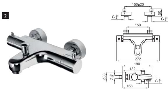
**1** BASIC - Наружный смеситель с термостатом для душа с элементом покрытия из воска. Связь 1/2". Включает обратный клапан и предохранитель на и ECOSTOP. Пропускная способность при 3 барах 25 л/мин.
