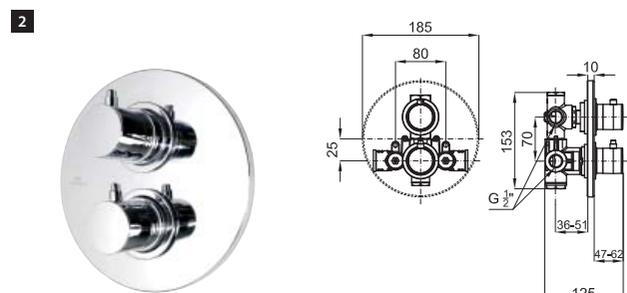
**1** BASIC - Смеситель с термостатом, скрытого монтажа, на 1 отверстие с элементом покрытия из воска. Связь 1/2". Пропускная способность при 3 барах - 25 л/мин. Включает обратный и предохранитель на 38°C
