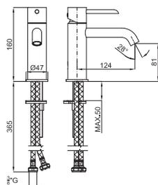
Однорычажный смеситель для раковины с керамическим картриджем Ø35 мм. Подключение 3/8", длина шлангов 365 мм, без автоматического клапана слива и с аэратор "plus". Открытие на холодную. Пропускная способность при 3 барах 5,34 л/мин.
