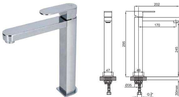
Однорычажный смеситель для раковины с высоким изливом и керамическим картриджем Ø25 мм. Подключение 3/8", длина шлангов 400-мм., без автоматического клапана слива слива и с аэратор "plus". Пропускная способность при 3 барах 5 л/мин.
