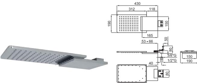
IRTA. Распылитель с функцией дождевого душа и каскада, с соединениями 1/2". Пропускная способность при 3 барах дождевого: 12,3 л/мин. и каскада: 8,80 л/мин.
