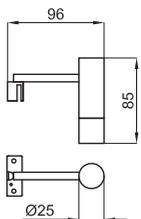
URBAN C. Бра LED Urban C 3 Вт для установки на зеркале. 12 V, IP44.
