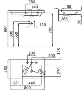
**1** Умывальная раковина 80x45 см, подвесная, с центрированным углублением и переливом. Включает крепежные элементы 100041225 - N421040000.
