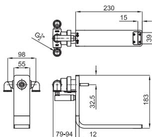
Однорычажный смеситель, скрытого монтажа, с керамическим картриджем Ø25 мм. Связь 1/2". Без клапана слива. Включает аэратор. Пропускная способность при 3 барах 5,1 л/мин.
