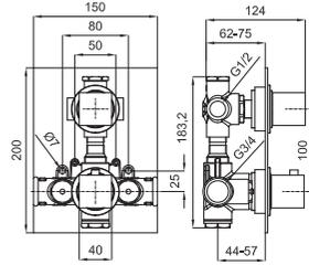
Смеситель с термостатом, скрытого монтажа, на 2 выхода с элементом покрытия из воска. Связи 1/2"- 3/4" согласно плану. Регулирующий переключатель давления. Пропускная способность при 3 барах - 1 выход 26 л/мин. и другой 13 л/мин. Включает обратный клапан и предохранитель на 38°C
