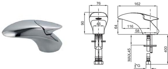
Однорычажный смеситель для раковины с керамическим картриджем 25 мм. Без донного клапана. Подключения 3/8", длина шлангов 400 мм. Аэратор "plus". Пропускная способность при 3 бар 5 л/мин.
