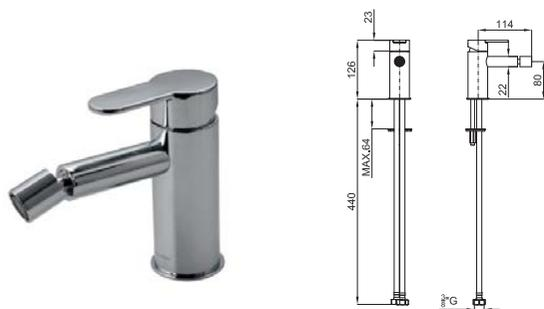
Однорычажный смеситель для биде. Керамический картридж Ø35 мм. Шланги с подключением 3/8" длиной 400 мм. Пропускная способность при 3 бар – 5.68 л/мин.
