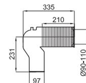
1 Регулируемое выпускное колено с уплотнителем для унитаза с направляемым выходом. Возможно подключение к канализационным трубам диаметром 90-110мм
