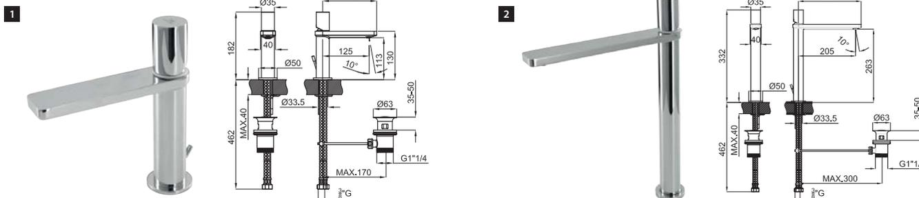
**1** Однорычажный смеситель для раковины с керамическим картриджем Ø25 мм. Подключение 3/8", длина шлангов 462мм. Автоматический сливной клапан и аэратор "plus". Открытие на холодную. Пропускная способность при 3 барах 4,27 л/мин.
