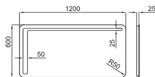
LOUNGE. Зеркало со светодиодной подсветкой в верхней и нижней части и системой предотвращающей запотевание 120X60 см. IP-44. LED температура 4200 K
