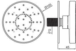
HOTELS - Боковая направляемая форсунка с системой AIR ECO, подключение 1/2".
