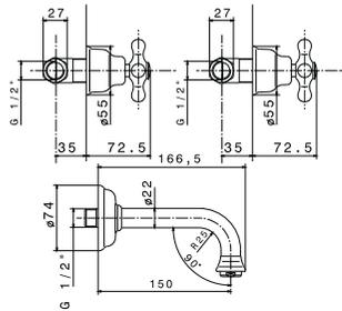
Смеситель для раковины, скрытого монтажа, настенный на 3 отверстия с керамическим картириджем. Связь 1/2", без клапана слива и аэратор "plus". Пропускная способность при 3 барах 18 л/мин.
