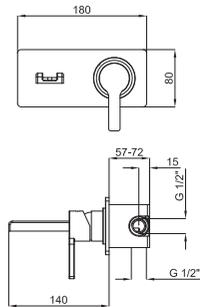
Однорычажный смеситель для раковины, скрытого монтажа, открытый излив с керамическим картриджем типа джойстик Ø25 мм. Связь 1/2", без клапана слива и без аэратора. Эффект падения воды каскадом. Пропускная способность при 3 барах 4 л/мин.
