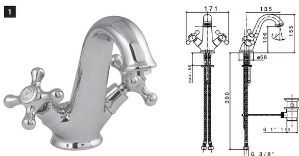
**1** Смеситель-моноблок для раковины с керамическим картриджем. Связь 3/8", длина шлангов 390-мм, с автоматическим клапаном слива и аэратор "plus". Пропускная способность при 3 барах 17,69 л/мин.
