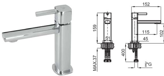
Однорычажный смеситель для раковины с керамическим картриджем Ø25 мм. Подключение 3/8", длина шлангов 400-мм., без автоматического клапана слива и с аэратор "plus". Открытие на холодную Пропускная способность при 3 барах 5 л/мин.
