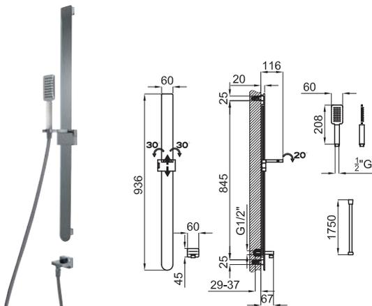
Комплект для душа Forma. В комплект входит душевая Пьедестал с реечным механизмом скольжения и поворотным кронштейном, ручной душ, гибкий шланг с системой анти-скручивания и покрытием из ПВХ, подвод воды
