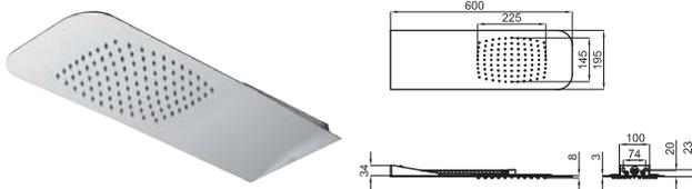
Распылитель дождевого душа с закругленными краем, 60 см. Пропускная способность при 3 барах 14 л/мин.
