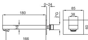
Излив, для ванны, с подключением 1/2". Аэратор "clean". Пропускная способность при 3 барах 21 л/мин.
