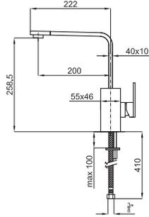
NEXT - Однорычажный смеситель для мойки, поворотный излив. Включает керамический картридж Ø35 мм, с подключением 3/8", длина шлангов 410-мм, аэратор "Plus" и обратный.
