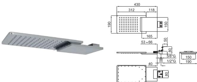
Распылитель с функцией дождевого душа и каскада, с соединениями 1/2". Пропускная способность при 3 барах дождевого: 12,3 л/мин. и каскада: 8,80 л/мин.
