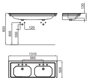
**1** Умывальная раковина-консоль 130 см, подвесная, с переливом. В комплект включен набор крепежных элементов 100041225 - N421040000. Совместима с комплектом ножек для консоли. С одним отверстием для смесителя
