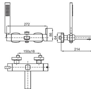
1 Наружный однорычажный смеситель для душа с керамическим картриджем Ø35 мм. Подключение 1/2". Расстояние между выходами 150 +/-15 мм. Включает гибкий шланг для душа 150 см, ручной душ и держатель для ручного душа.
