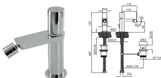
Однорычажный смеситель для биде с керамическим картриджем Ø25 мм. Подключение 3/8", длина шлангов 487мм. Автоматический сливной клапан и аэратор "plus". Открытие на холодную. Пропускная способность при 3 барах 10,8 л/мин.
