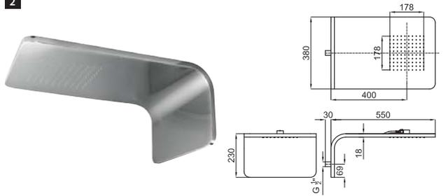
1 LOUNGE. Распылитель с функцией дождевого душа и каскада, с соединениями 1/2". Пропускная способность при 3 барах Функция дождь 10,8 л/мин. и функция каскад 11,4 л/мин
