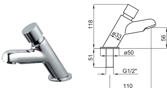
Смесители для раковины с таймером воды. Рекомендуемое давление 3 бар. Время функционирования 15 +/-5 сек. в 3 бара. Пропускная способность при 3 барах 16,80 л/мин.
