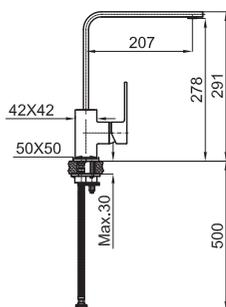
NK - Однорычажный смеситель для мойки с керамическим картриджем Ø40 мм, с подключением 3/8", длина шлангов 341-мм, аэратор "plus". Поворотный излив.
