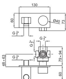
Держатель для ручного душа с выходом для воды и переключатель с подключением 1/2". Пропускная способность при 3 барах душа: 15 л/мин., ванны: 25 л/мин. и верхний душ: 17 л/мин.
