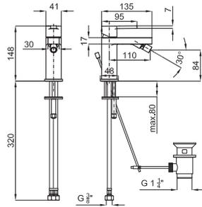
Однорычажный смеситель для биде с керамическим картриджем Ø25 мм. Связь 3/8", длина шлангов 320-мм., с автоматическим клапаном слива и аэратор "plus". Пропускная способность при 3 барах 10,05 л/мин.
