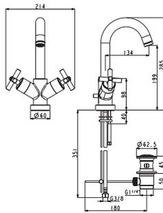
Смеситель-моноблок с керамическим картриджем (открытие 90°). Связь 3/8", длина шлангов 350-мм, с автоматическим клапаном слива и аэратор "plus". Пропускная способность при 3 барах (со смешанной водой) 12,78 л/мин.
