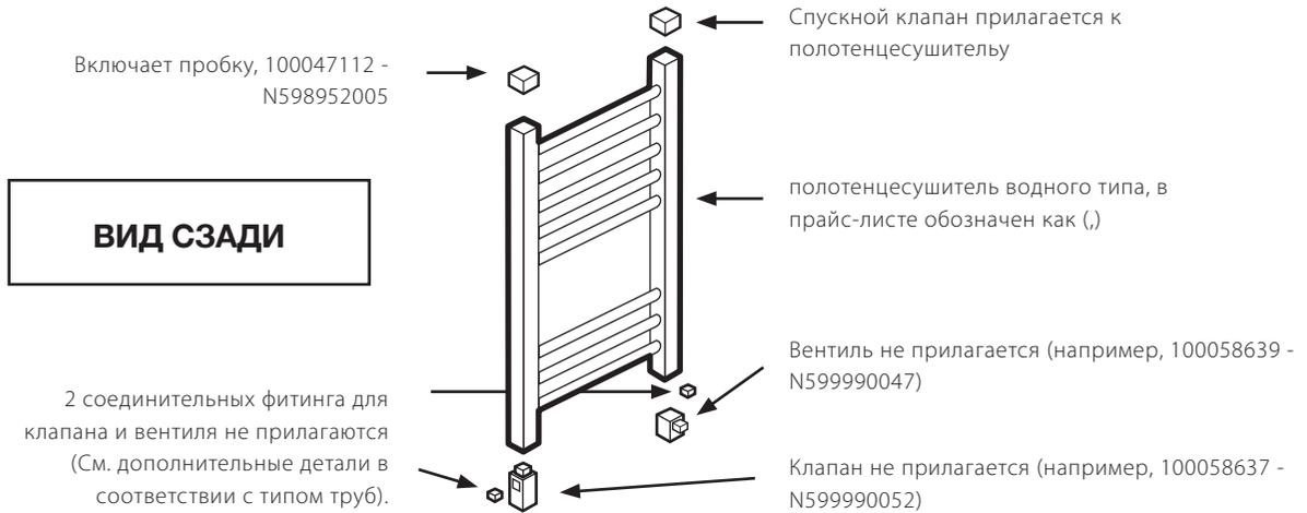
К полотенцесушителю водного типа прилагаются Спускной клапан и настенные крепления. При хромированном или белом полотенцесушителе должны заказываться хромированные фитинги.
