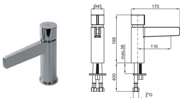
Однорычажный смеситель для раковины с керамическим картриджем. Без донного клапана. Подключение 3/8" длина шлангов - 400мм и плоский аэратор. Пропускная способность при 3 бар 5 л/мин.
