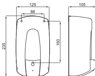
Стальной, антивандалный дозатор мыла наполняемый со смотровым окном и кнопкой предотвращающей образование капель. Емкость 0,9л.
