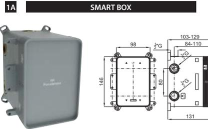
**1A** SMART BOX - Универсальный встроенный корпус быстрой установки для термостатических смесителя с 1, 2 или 3 выходами. С восковым термозащитным элементом и подключением 1/2". Пропускная способность всех трех выходов при давлении 3 бар составляет 20,2 л/мин. В комплект входят 2 глушителя шума и 2 заглушки 1/2".
