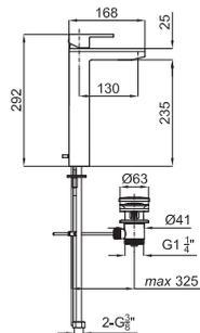
Однорычажный смеситель для раковины с высоким изливом и керамическим картриджем Ø35 мм, связь 3/8", длина шлангов 370-мм, с автоматическим клапаном слива и аэратор "plus". Пропускная способность при 3 барах 12,01 л/мин.
