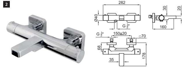
**1** URBAN. Наружный смеситель с термостатом для душа с элементом покрытия из воска. Связь 1/2". Включает обратный клапан и предохранитель на 38 ° и ECOSTOP. Расстояние между выходами 150 +/-20 мм. Пропускная способность при 3 барах 12 л/мин.
