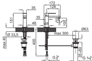
Однорычажный смеситель для раковины, хромированный с керамический картриджем Ø25 мм. Связь 3/8", длина шлангов 405-мм, с автоматическим клапаном слива и аэратор "plus". Пропускная способность при 3 барах 10,5 л/мин.
