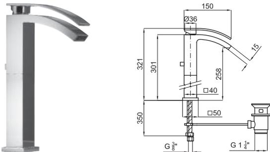
Однорычажный смеситель для раковины с высоким изливом и керамическим картриджем Ø28 мм. Связь 3/8", длина шлангов 350-мм, с автоматическим клапаном слива и без аэратор. Падение воды каскадом. Пропускная способность при 3 барах 7,51 л/мин.
