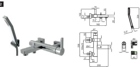
1 Наружный однорычажный смеситель для душа с керамическим картриджем Ø35 мм. Связь 1/2". Расстояние между выходами 150 +/-15 мм. Он включает гибкие шланги для душа 150 см., ручной душ и держатель для ручного душа. Пропускная способность при 3 барах 11,7 л/мин.
