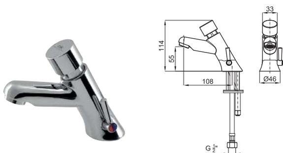
Смесители для раковины с таймером. Рекомендуемое давление функционирования 3 бар. Время функционирования 15 +/-5 сек. в 3 барах. Пропускная способность при 3 барах 13,06 л/мин.
