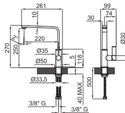
SOFT - Однорычажный смеситель для мойки, поворотный излив. Включает керамический картридж Ø25 мм, с подключением 3/8", длина шлангов 500-мм. Аэратор "Plus"
