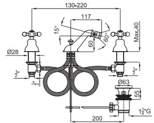
**1** Смеситель-моноблок для биде с керамическим картириджем. Связь 3/8", длина шлангов 390-мм, с автоматическим клапаном слива и аэратор "plus". Пропускная способность при 3 барах 18,51 л/мин.
