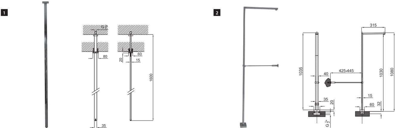
**1** Излив для раковины, монтируемый в потолок. Связь 1/2", без клапана слива и аэратор "plus". Внимание: он включает только излив. Пропускная способность при 3 барах 12,2 л/мин.
