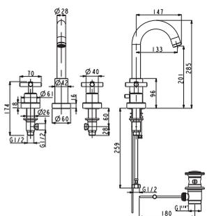
Смеситель для раковины на 3 отверстия с керамическим картриджем. Связь 1/2", длина шлангов 259-мм, с автоматическим клапаном слива и аэратор "plus". Пропускная способность при 3 барах 12,78 л/мин.
