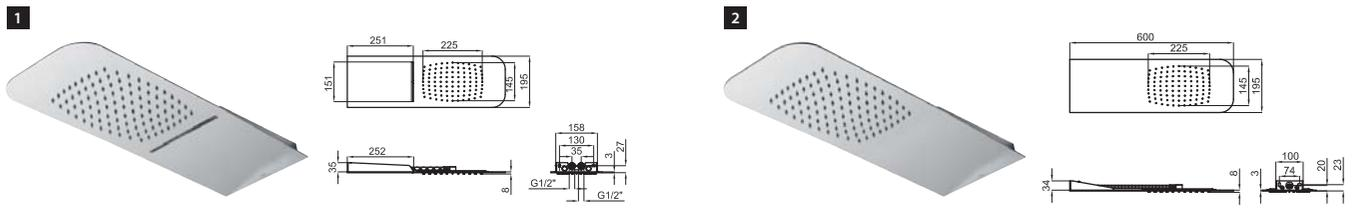
**1** GIRO. Распылитель душевого душа с закругленными краем, 60 см, дождевой + каскадный. Пропускная способность при 3 барах дождевого: 14 л/мин. и каскада: 15,50 л/мин.
