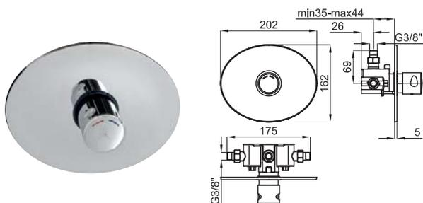
Встраиваемый смеситель для душа с таймером. Связь 3/8". Рекомендуемое давление 3 бар. Время функционирования 25 +/-5 сек. в барах. Пропускная способность при 3 барах 20 л/мин.
