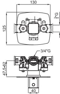
Смеситель с термостатом, скрытого монтажа, с элементом покрытия из воска. Связь 3/4". Он включает обратный и предохранитель на 38°C. Пропускная способность при 3 барах 60 л/мин.
