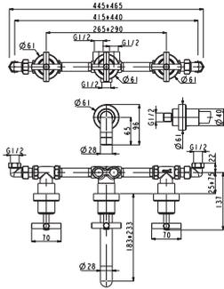
Смеситель, скрытого монтажа, для ванны / душа на 3 отверстия с керамическим картириджем. Связь 1/2" и ручной переключатель регулирующий давление. Пропускная способность при 3 барах для душа: 16 л/мин. и для ванны : 22 л/мин
