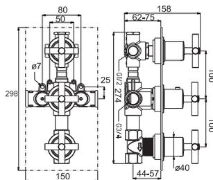
Смеситель с термостатом, скрытого монтажа, на 3 отверстия с элементом покрытия из воска. Связи 1/2"- 3/4" согласно плану и регулирующий переключатель давления. Пропускная способность при 3 барах - выхода 26 л/мин., второй из 16 л/мин. и третий 45,5 л/мин. Он включает 1 выход большого давления с независимым ручным душем, клапан анти-возвращения и предохранитель на 38°C
