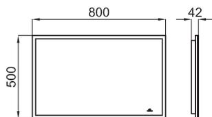
TILE. Горизонтальное зеркало 80x50 см, со светодиодной подсветкой по периметру. II класс электробезопасности, IP44, 50 Вт, температура цвета 6000K.
