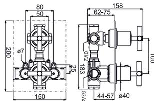
Смеситель с термостатом, скрытого монтажа, на 2 отверстия с элементом покрытия из воска. Связи 1/2"- 3/4" согласно плану и ручной переключатель. Пропускная способность при 3 барах - для ванны 26 л/мин. и душ 13 л/мин. включает клапан анти-возвращения и предохранитель на 38°C
