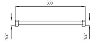
1 Гибкий шланг подключения 1/2" x 3/8" гайка-гайка, 300мм
