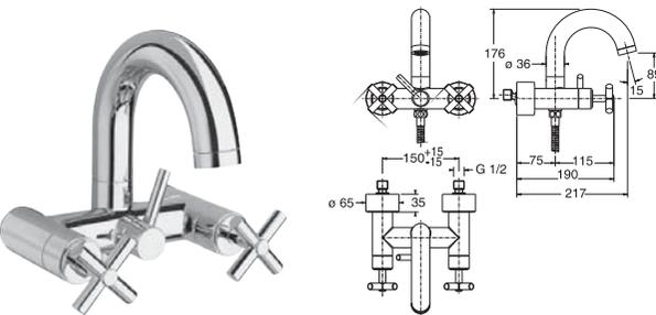
Наружный смеситель-моноблок для ванны / душа с керамическим картриджем. Связь 1/2", ручной переключатель и азратор "plus". Расстояние между выходами 150 +/-15 мм. Пропускная способность при 3 барах 33 л/мин.
