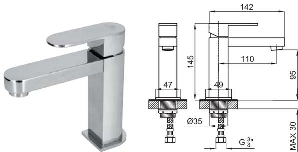
Однорычажный смеситель для раковины с керамическим картриджем Ø25 мм. Подключение 3/8", длина шлангов 370-мм., без автоматического клапана слива слива и с аэратор "plus". Пропускная способность при 3 барах 5 л/мин.
