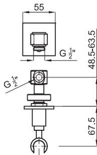
Настенный держатель для ручного душа сподводом воды
