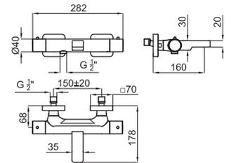
1 Наружный смеситель с термостатом для душа с элементом покрытия из воска. Связь 1/2". Включает обратный клапан и предохранитель на 38 ° и ECOSTOP. Расстояние между выходами 150 +/-20 мм. Пропускная способность при 3 барах 12 л/мин.
