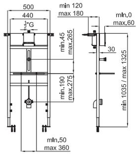
Рама для подвесного писсуара с инфракрасной системой смыва для установки в тонкую стену. В комплект входит панель с инфракрасным сенсором, крепежные элементы и соединения с писсуаром.
