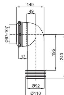
1 Выпускное колено для унитаза с направляемым выходом с уплотнителем, возможно подключение к канализационным трубам диаметром 90-110мм
