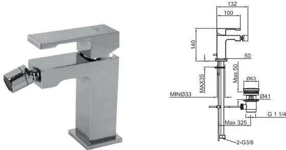
Однорычажный смеситель для биде с керамическим картриджем Ø25 мм., с подключением 3/8", длина шлангов 370-мм, с автоматическим клапаном слива и аэратор clean. Пропускная способность при 3 барах 9,96 л/мин.
