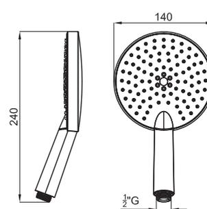
1 PURE LINE. Ручной душ с переключателем и системой AIR ECO. Пропускная способность при 3 бар 12,8 л/мин.
