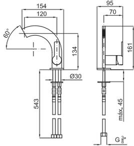
Однорычажный смеситель для биде с керамическим картриджем Ø28 мм. Связь 3/8", длина шлангов 460-мм, с плоским падением воды и без клапана слива. Пропускная способность при 3 барах 5,82 л/мин.
