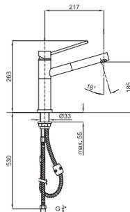
PAL - Однорычажный смеситель для мойки, поворотный излив, с выдвижным душем. Включает керамический картридж Ø35 мм, с подключением 3/8", длина шлангов 1500-мм, /530мм, аэратор "Plus" и клапан слива анти-возвращение.
