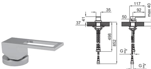
Независимый однорычажный смеситель. Связь 3/8" без клапана слива. Пропускная способность при 3 барах 11,03 л/мин.
