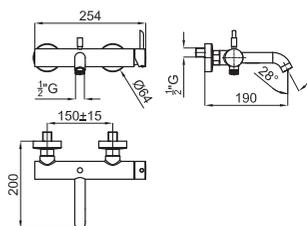
Наружный однорычажный смеситель для ванны / душа с керамическим картриджем Ø35 мм., связь 1/2", полуавтоматический переключатель и азратор "plus". Расстояние между выходами 150 +/-15 мм. Пропускная способность при 3 барах душа: 20,96 л/мин. и ванны: 15,98 л/мин.
