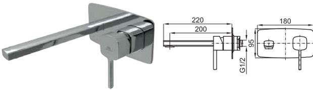
1 Внешняя часть, встроенного смесителя для раковины с керамическим картриджем 35мм. Без донного клапана. Пропускная способность воды при 3 барах - 5 л/мин. Возможность горизонтального и вертикального монтажа.
