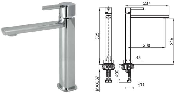
Однорычажный смеситель для раковины 305 мм с высоким изливом и керамическим картриджем Ø25 мм. Подключение 3/8", длина шлангов 400-мм. Открытие на холодную, без автоматического сливного клапана и с аэратором "plus". Пропускная способность при 3 барах 5 л/мин.
