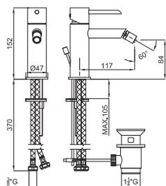
Однорычажный смеситель для биде с керамическим картриджем Ø35 мм, с подключением 3/8", длина шлангов 370-мм, с автоматическим клапаном слива и азратор plus. Открытие на холодную. Пропускная способность при 3 барах 11,73 л/мин.
