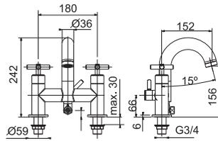
Смеситель-моноблок для ванны / душа, установка на ванну с керамическим картириджем. Подключение 3/4", ручной переключатель и аэратор "plus". Расстояние между выходами 180 мм. Пропускная способность при 3 барах 35 л/мин.
