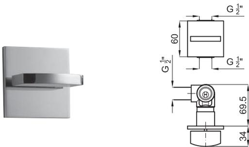
Переключатель скрытого монтажа на 2 выхода. Связь 1/2". Переключатель ручной. Пропускная способность при 3 барах 25,71 л/мин.
