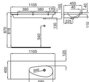
1 Раковина 110см подвесная с перемещенным углублением направо, слив и крепления 100041225 - N421040000. Держатель полотенец не включает. С отверстием для смесителя
