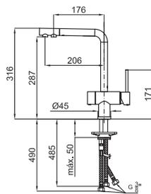
OSMOSIS - Однорычажный смеситель для мойки, поворотный излив, для фильтрации осмос, с керамическим картриджем, Ø35 мм, с подключением 3/8", длина шлангов 485-мм, Смеситель не включает комплект фильтров. Аэратор "Plus".
