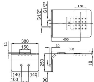
**1** Распылитель с функцией дождевого душа, с соединениями 1/2". Пропускная способность при 3 барах 10,75 л/мин.
