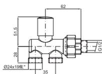
Клапан для однострунной системы вертикальный
