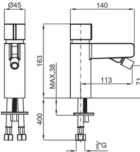
Смеситель для биде с керамическим картриджем. Подключения 3/8" и длина шлангов 400мм. Плоский аэратор. Пропускная способность при 3 бар 5 л/мин.
