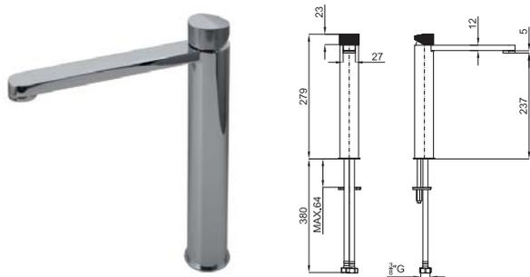
Однорычажный смеситель для раковины с высоким изливом и ребристой ручкой. Керамический картридж Ø25 мм. Шланги с подключением 3/8" длиной 500мм. Пропускная способность при 3 бар – 5.68 л/мин.
