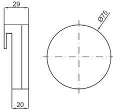
FORMA. Бра LED круглой формы 5Вт для установки на зеркале. 12 V, IP44.
