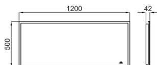
TILE. Горизонтальное зеркало 120x50 см, со светодиодной подсветкой по периметру. II класс электробезопасности, IP44, 75Вт, температура цвета 6000K.
