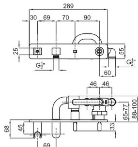
Однорычажный смеситель, скрытого монтажа, для ванны / душа + держатель + подход для воды. Связь 1/2". Автоматический переключатель. Пропускная способность при 3 барах 16,26 л/мин.
