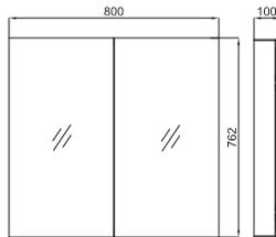
Шкаф Универсальный встроенный с двумя дверцами и двойным зеркалом 80x76,2x10 см. Зеркало со встроенной системой предотвращающей запотевание. Максимальная мощность электроприбора подключаемого в розетку - 500Вт. 2 стеклянные полочки регулируемые по высоте. Зеркальная задняя стенка. Петли с системой мягкого закрывания. Блестящий алюминиевый профиль "soft line". Класс электробезопасности II.
