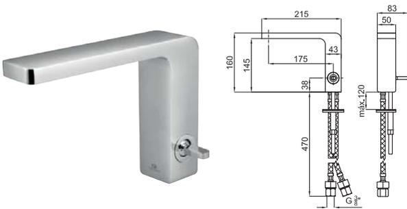
Однорычажный смеситель для раковины с керамическим картриджем Ø25мм. Связь 3/8". Длина шлангов 470 мм, без клапана слива. Включает аэратор, вкрученный в излив, который симулирует эффект каскадом, кроме того смеситель со стопором давления в 8 л/мин, чтобы предотвращать забрызгивание.
