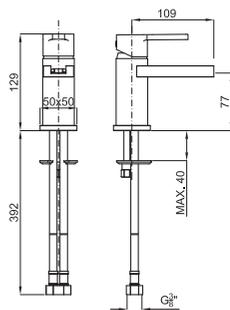
Однорычажный смеситель для биде с керамическим картриджем Ø25 мм. Связь 3/8", длина шлангов 390-мм, без клапана слива. Падение воды каскадом. Пропускная способность при 3 барах 4 л/мин.
