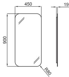
SMART LINE. Зеркало 45x90 см вертикальное со шлифованными краем.
