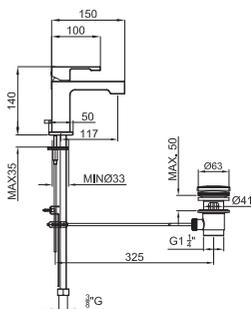
Однорычажный смеситель с керамическим картриджем Ø25 мм. Связь 3/8", длина шлангов 370-мм, с автоматическим клапаном слива luxe и аэратор clean. Пропускная способность при 3 барах 5 л/мин.
