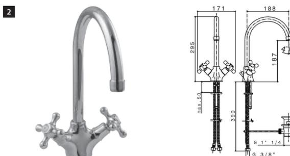
**2** Смеситель-моноблок с керамическим картриджем. Связь 3/8", длина шлангов 390-мм, с автоматическим клапаном слива и аэратор "plus". Пропускная способность при 3 барах 18,75 л/мин.
