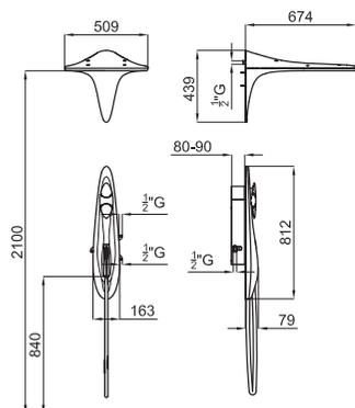
Душевая колонка. Включает смеситель и ручной душ со встроенным держателем.
