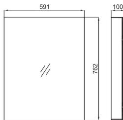
Шкаф Универсальный встроенный с одной дверцей и двойным зеркалом с подсветкой 59,1x76,2x10 см. Зеркало со встроенной системой предотвращающей запотевание. Максимальная мощность электроприбора подключаемого в розетку - 500Вт. 2 стеклянные полочки регулируемые по высоте. Зеркальная задняя стенка. Петли с системой мягкого закрывания. Блестящий алюминиевый профиль "soft line". Класс электробезопасности II.
