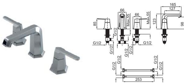
Смеситель для раковины на 3 отверстия с керамическим картриджем. Связь 1/2", без клапана слива. Пропускная способность при 3 барах 9 л/мин.
