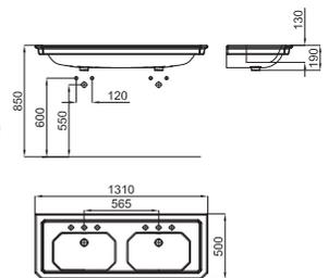
1 Умывальная раковина-консоль 130 см, подвесная, с переливом. В комплект включен набор крепежных элементов 100041225 - N421040000. Совместима с комплектом ножек для консоли. С одним отверстием для смесителя
