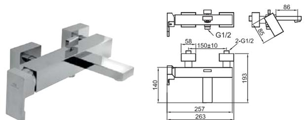
1 Наружный однорычажный смеситель для душа с керамическим картриджем 35-мм и связью 1/2". Расстояние между выходами 150 +/-10 мм. Пропускная способность при 3 барах 25,74 л/мин.
