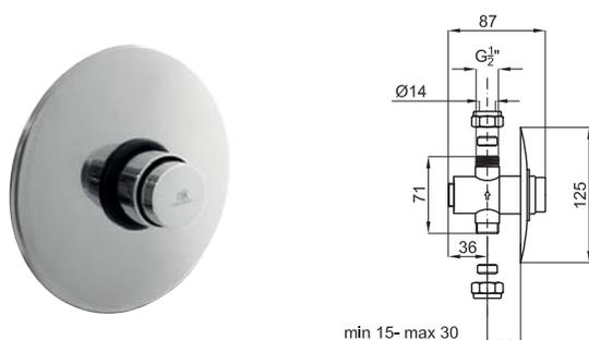
Смеситель для душа, скрытого монтажа, с таймером. Связь 1/2". Рекомендуемое давление 3 бар. Время функционирования 15 +/-5 сек. в барах. Пропускная способность при 3 барах 17 л/мин.
