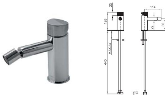
Однорычажный смеситель для биде с ребристой ручкой. Керамический картридж Ø35 мм. Шланги с подключением 3/8" длиной 400 мм. Пропускная способность при 3 бар – 5.68 л/мин.
