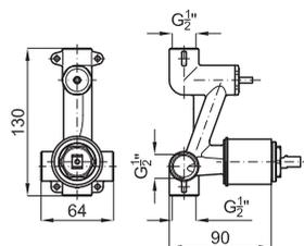
PROJECT LINE - Внутренняя часть встроенного смесителя для ванны/душа с керамическим картриджем 35мм автоматическим инвертором и подключениями 1/2". Пропускная способность при 3х барах со смешанной водой: ванная 20л/мин и душ 18л/мин.
