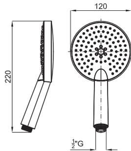
Ручной душ с переключателем и системой AIR ECO. Пропускная способность при 3 бар 12,8 л/мин.
