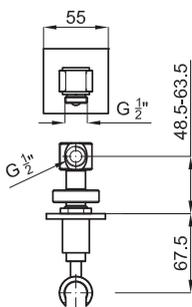
Настенный держатель для ручного душа сподводом воды
