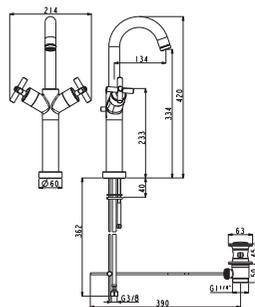
Смеситель-моноблок высоким изливом и керамическим картриджем. Связь 3/8", длина шлангов 362-мм, с автоматическим клапаном слива и аэратор "plus". Пропускная способность при 3 барах 12,78 л/мин.
