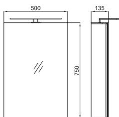
Шкаф подвесной с одной дверцей и двойным зеркалом с подсветкой 50x75x13,5 см. Сенсор включения подсветки. Зеркало со встроенной системой предотвращающей запотевание. Максимальная мощность электроприбора подключаемого в розетку - 500Вт, 2 стеклянные полочки регулируемые по высоте. Зеркальная задняя стенка. Петли с системой мягкого закрывания. Блестящий алюминиевый профиль "soft line". Класс электробезопасности II.
