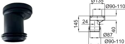
Эксцентриковый манжет для унитаза с вертикальным выходом позволяет небольшое боковое перемещение. Для подключения унитаза с вертикальным выходом к канализационным трубам 90-110мм.
