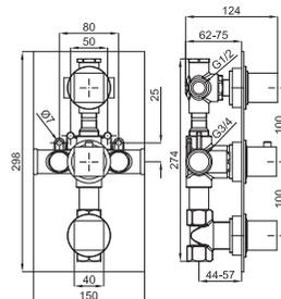
Смеситель с термостатом, скрытого монтажа, на 3 отверстия с элементом покрытия из воска. Связи 1/2"- 3/4" согласно плану. Регулирующий переключатель давления. Пропускная способность при 3 барах - 1 выход 26 л/мин, другой 16 л/мин. и последний 45,5 л/мин. Включает 1 выход с большой пропускной способностью и независимой ручкой, обратный клапан и предохранитель на 38°C.
