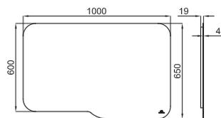
FORMA. Зеркало 100x65 см горизонтальное со шлифованными краем.
