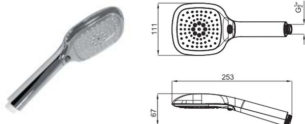
URBAN - Ручной душ с 2 функциями, с переключателем функций дождевого душа и массажа. Пропускная способность при 3 барах : ДОЖДЬ = 11,78 л/мин.; МАССАЖ = 12,06 л/мин.; ДОЖДЬ+МАССАЖ = 15,14 л/мин.
