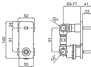
Однорычажный смеситель для ванны / душа скрытого монтажа. Связь 1/2". Автоматический переключатель. Пропускная способность при 3 барах 16,58 л/мин.
