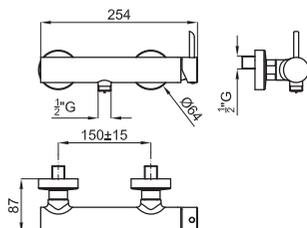
Наружный однорычажный смеситель с керамическим картриджем Ø35 мм. и связь 1/2". Расстояние между выходами 150 +/-15 мм. Пропускная способность при 3 барах 22,11 л/мин.
