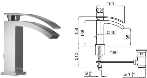
Однорычажный смеситель для раковины с керамическим картриджем Ø28 мм. Связь 3/8", длина шлангов 512-мм, с автоматическим клапаном слива и без аэратора. Падение воды каскадом. Пропускная способность при 3 барах 7,85 л/мин.
