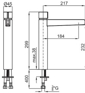
Смеситель для раковины с высоким изливом и керамическим картриджем. Без донного клапана, подключения 3/8", длина шлангов 400мм, плоский аэратор. Пропускная способность при 3 бар 5 л/мин.
