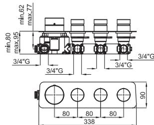
Термостатический смеситель скрытого монтажа на 3 выхода с термоэлементом из воска и обратным клапаном. Подключения 3/4". Пропускная способность при 3 бар 20,4 л/мин для одного выхода и 25,9 л/мин при включении двух выходов.
