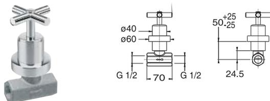
Перепускной вентиль, скрытого монтажа 1/2". Пропускная способность при 3 барах 29,33 л/мин.
