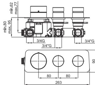
Термостатический смеситель скрытого монтажа на 2 выхода с термоэлементом из воска и обратным клапаном. Подключения 3/4". Пропускная способность при 3 бар 20,4 л/мин для одного выхода и 25,9 л/мин при включении двух выходов.
