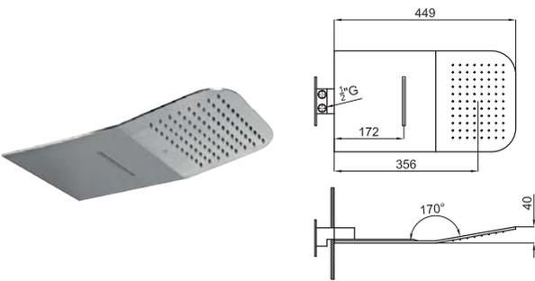
FORMA. Распылитель с функцией дождевого душа и каскада, подключение 1/2". Пропускная способность при 3 барах дождевого душа: 9 л/мин. и каскада: 9 л/мин.
