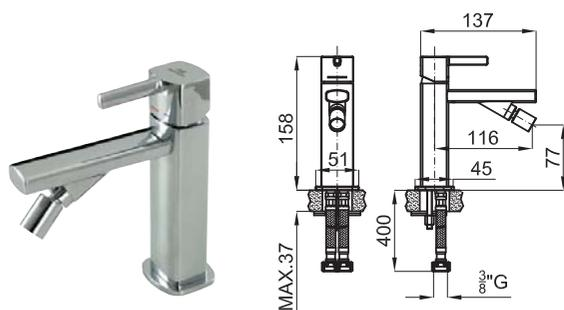
Однорычажный смеситель для биде с керамическим картриджем Ø25 мм. Подключение 3/8", длина шлангов 400-мм, без автоматического сливного клапана и с аэратором "plus" "plus". Пропускная способность при 3 барах 5 л/мин.
