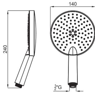
Ручной душ с переключателем и системой AIR ECO. Пропускная способность при 3 бар 14,1 л/мин.
