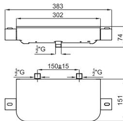
Наружный смеситель белое стекло с термостатом для душа с элементом покрытия из воска. Связь 1/2". Включает обратный клапан и предохранитель на 38°. Расстояние между выходами 150 +/- 15 мм. Пропускная способность при 3 барах 14,8 л/мин
