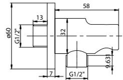
1 Настенный держатель для ручного душа, с подводом воды
