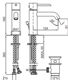
Однорычажный смеситель для раковины с керамическим картриджем Ø35 мм. Подключение 3/8", длина шлангов 365 мм. Автоматический сливной клапан и аэратор "plus". Открытие на холодную. Пропускная способность при 3 барах 5,34 л/мин.
