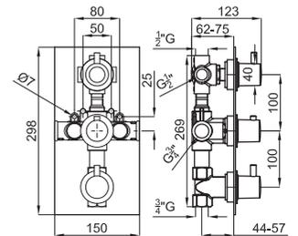
1 URBAN. Смеситель с термостатом, скрытого монтажа, на 3 отверстия с элементом покрытия из воска. Связи 1/2" - 3/4" согласно плану. Регулирующий переключатель давления. Пропускная способность при 3 барах - 1 выход 26 л/мин., другой с 16 л/мин. и последний 45,5 л/мин. Включает 1 выход большого давления с независимым ручным душем, клапан слива анти-возвращения и предохранитель на 38°C
