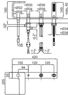
Смеситель для ванны на 4 отверстия. Он включает 1 тип пульта, излив для ванны, переключатель и ручной душ со шлангом 150-см. Связь 1/2". Пропускная способность при 3 барах ванна: 13,64 л/мин. и душа: 13,76 л/мин.
