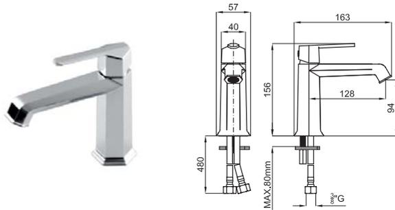
Однорычажный смеситель для раковины с керамическим картриджем Ø25 мм. Связь 3/8", длина шлангов 480-мм, без клапана слива. Пропускная способность при 3 барах 9 л/мин.
