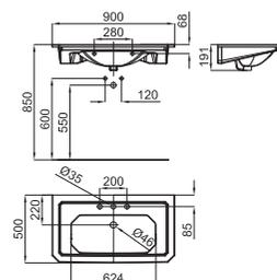
**1** Умывальная раковина-консоль 90 см, подвесная, с переливом. В комплект включен набор крепежных элементов 100041225 - N421040000. Совместима с комплектом ножек для консоли. С одним отверстием для смесителя
